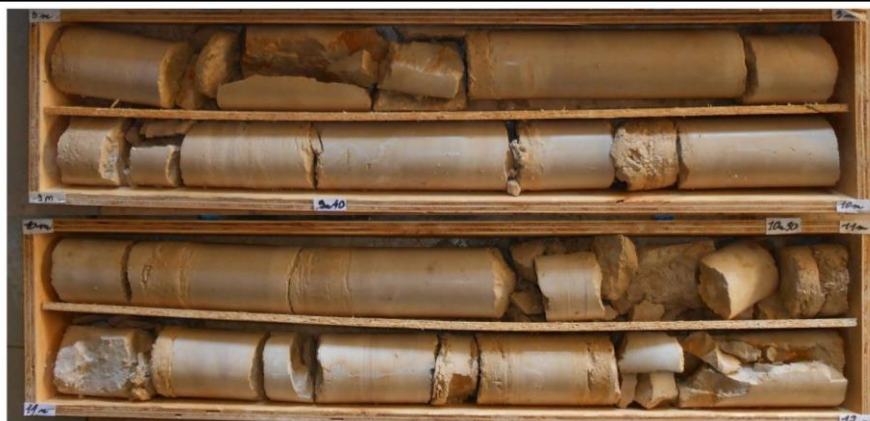
Figure 10 : Carotte du sondage carotté CA06 caractéristique du calcaire de Levroux (Géocentre, 2016)
